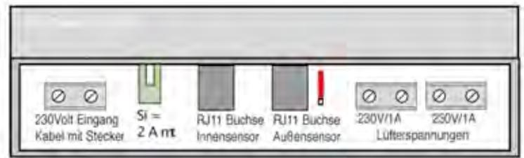
Um die Tastatursperre ein- oder auszuschalten ziehen Sie zuerst den Netzstecker. Dann öffnen Sie den Anschlußkasten mit einem Schraubenzieher. Rechts neben der Buchse des Außenfühlers befindet sich ein Schiebeschalter mit einem roten Schieber. Um unbefugten Programmwechsel zu unterbinden, kann die Prog Taste gesperrt werden, indem man den Schieber nach unten schiebt. Schiebt man den Schieber wieder nach oben, ist die Prog Taste wieder funktionsfähig.
