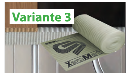
Variante 3 Verklebung von Parkett oder Fliesen nach Verlegung der selbstklebenden XeroMat Entkopplungsmatte mit 5 cm Überlappung. FLIESENBELAG: Es kann direkt mit der Verlegung des Fliesenbelages begonnen werden. PARKETT: Es wird empfohlen die XeroMat Entkopplungsmatte oberseitig mit einer handelsüblichen Spachtelmasse auf Zementbasis eben abzuziehen, um einen unnötig hohen Verbrauch von Parkettkleber zu vermeiden
