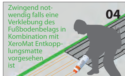
04 Verkleben der Xeros Trockenbauplatten mit dem Untergrund mittels geeignetem Kleber (z.B. PU-Trockenestrichkleber) Siehe unten - Belagsvariante 3
