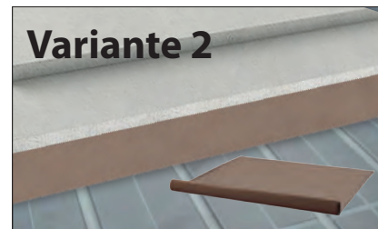
Variante 2 Verlegung eines Trockenestriches, bestehend aus 20mm starken Trockenestrich-Elementen mit 50 mm breitem Stufenfalz (Stufenfalz geklebt und verschraubt), nach Abdeckung der gesamten Fläche mit XeroKraft Baupapier mit 5 cm Überlappung.
